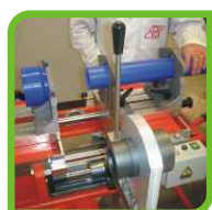
SALDATURA DI TESTA BUTT WELDING
